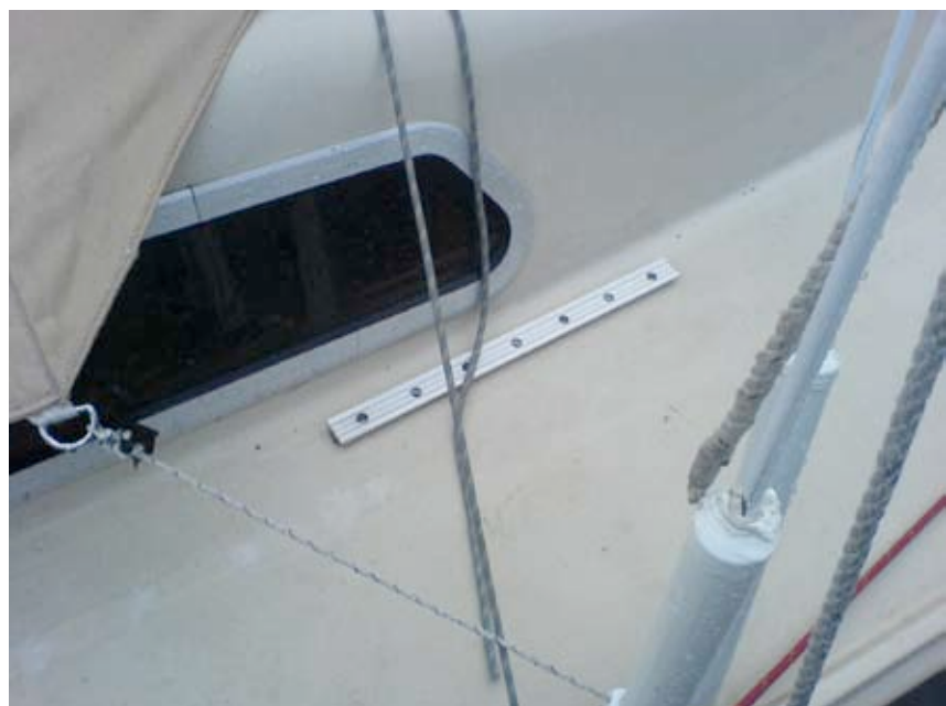
Fockskena i rätt position. Man kan se hålen från originalskenans montage.
